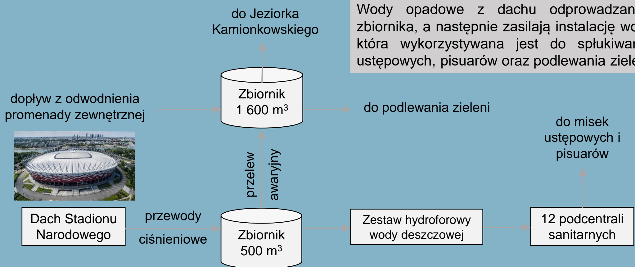
Rys. Schemat blokowy instalacji dualnej na Stadionie Narodowym [Dokumentacja Narodowego Centrum Sportu Sp.z o.o.]
