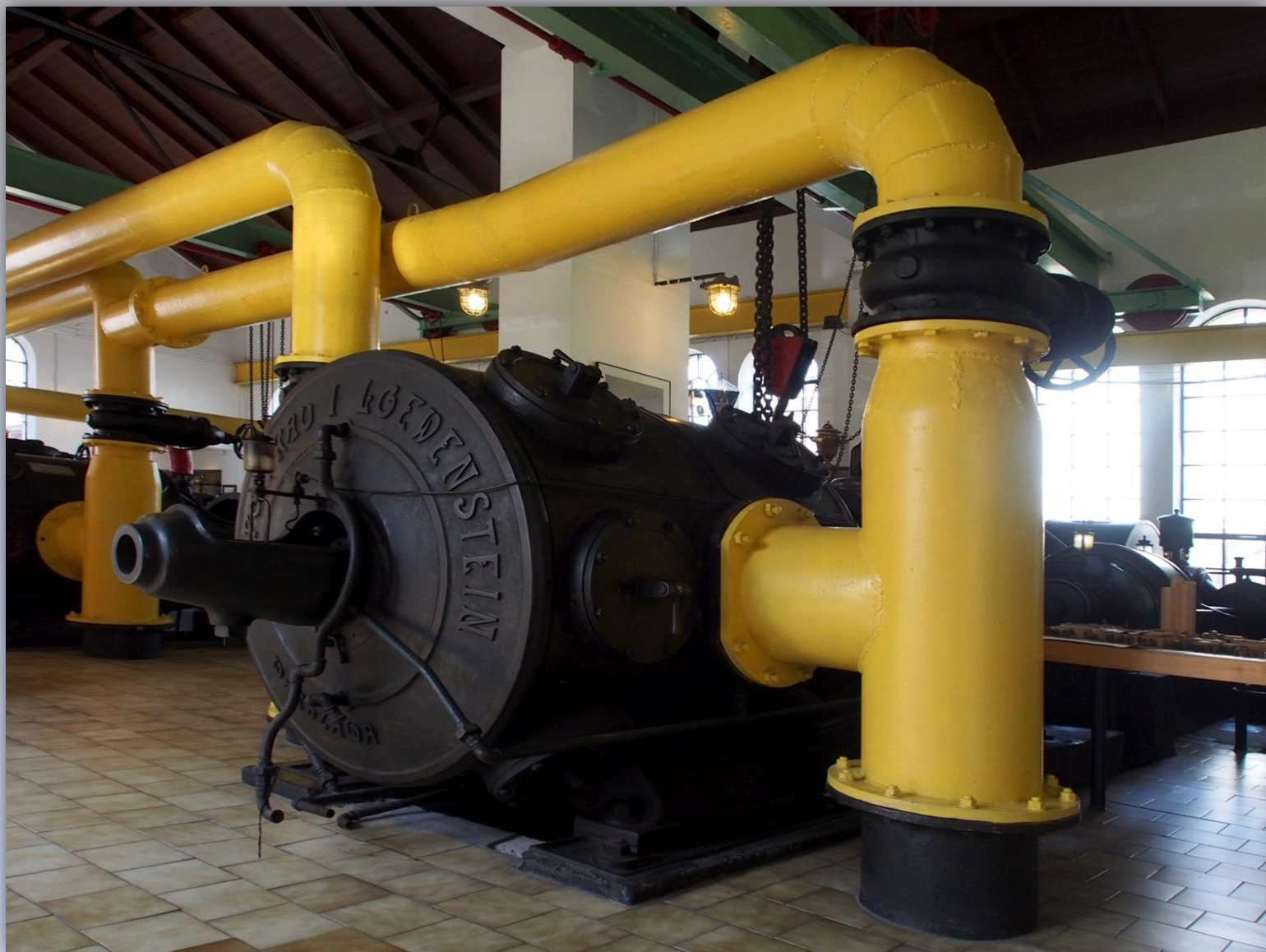
Sprężarka do gazu wyprodukowana w wolskich zakładach w latach 20-tych XX w.
